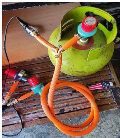
Gambar 7. Pemasangan Sensor pada tabung gas LPG
