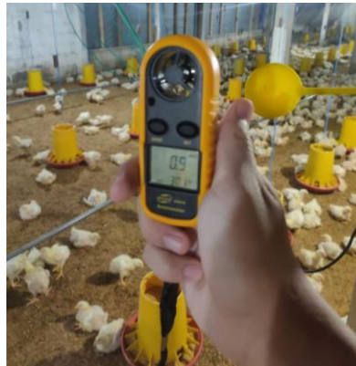
Gambar 4 Pengujian Kcepatan Angin
